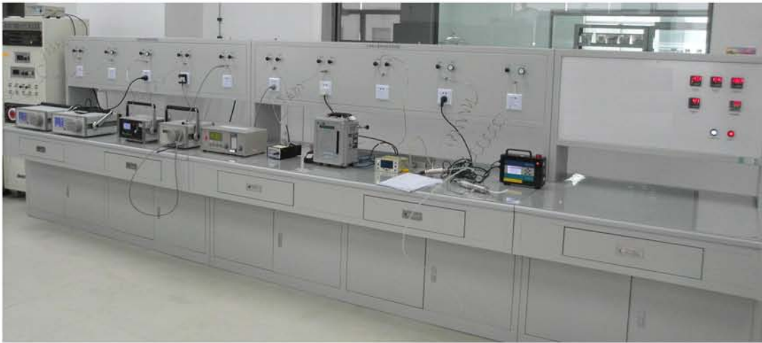
一次同时校准十台露点仪的露点发生器
